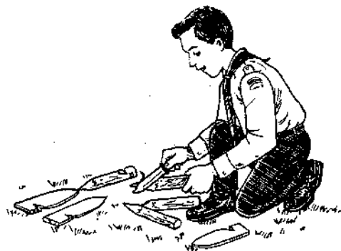
Rajah 4.3 Membuat kayu pancang dengan menggunakan pisau dan parang
